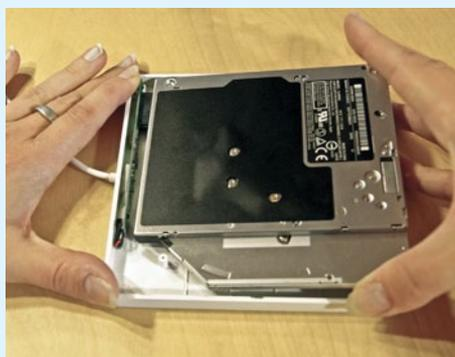
**24** Legen Sie das DVD-Laufwerk ins Gehäuse, und verbinden Sie es mit der Schnittstelle. Nun nur noch das Gehäuse wieder schließen, und Sie sind fertig.
