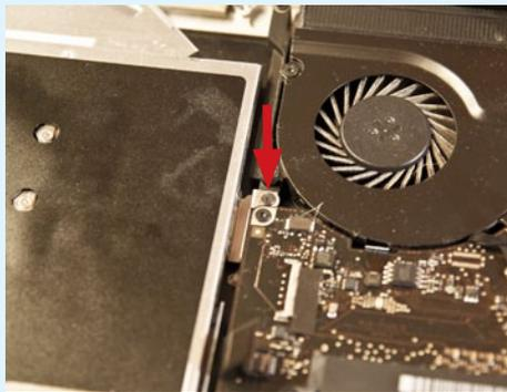
**15** Entfernen Sie die Schraube rechts beim Lüfter, die das DVD-Laufwerk am Gehäuse fixiert. →
