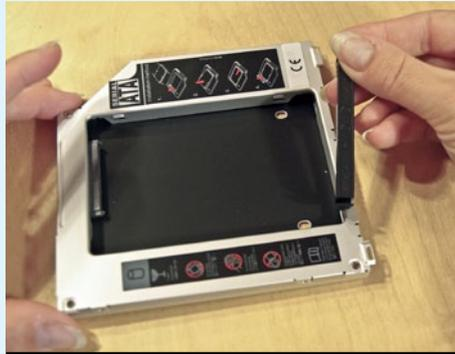
**20** Danach entfernen Sie den eingeklemmten Abstandhalter aus Kunststoff am Einbau-rahmen für die Festplatte. →
