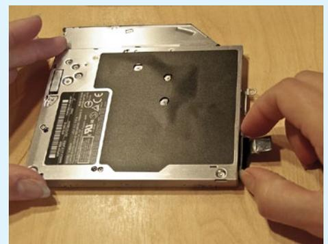
**18** Entfernen Sie den Verbindungskontakt, über den das Laufwerk Daten mit der Platine austauscht. →
