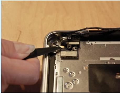
**13** Entfernen Sie die Stecker für die Bluetooth-Antenne vorsichtig mit dem Spatel. Lösen Sie danach die zwei Schrauben, die die Bluetooth-Platine fixieren. →
