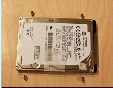
**8** Entfernen Sie alle vier Schrauben an den Seiten, und schrauben Sie diese an gleicher Stelle an die SSD. Diese können Sie nun anschließen, einsetzen und festschrauben.
