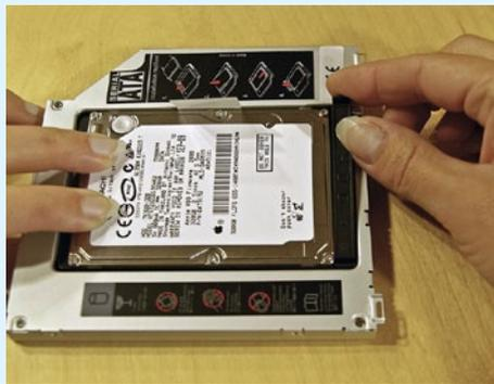
**22** Setzen Sie den Abstandhalter ein. Jetzt können Sie den Rahmen mit dem Laufwerk einsetzen, alle Verbindungen wiederherstellen und das Gerät zusammensetzen.
