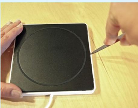
**23** Öffnen Sie das externe Gehäuse, um das DVD-Laufwerk einzusetzen, im Beispiel mit dem Spatel. →
