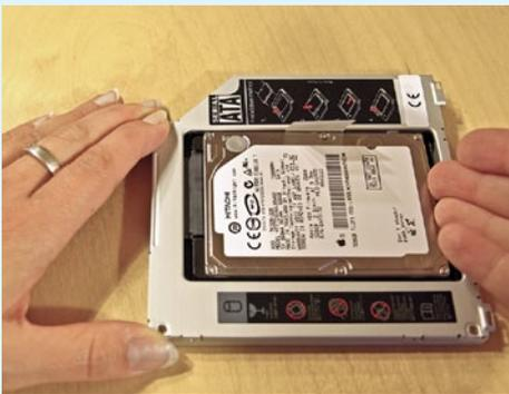
**21** Legen Sie die Festplatte in den Rahmen, und drücken Sie diese gegen die Kontaktstelle, bis eine feste Verbindung besteht. →
