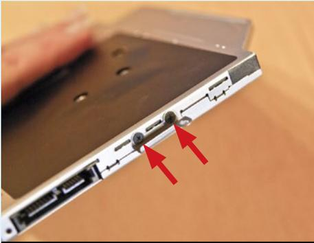
**19** Schrauben Sie auch den Halter für die Befestigung am Gehäuse ab, und bauen Sie ihn an den Einbau-rahmen für die Festplatte. →
